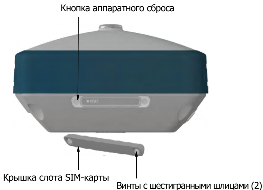
Рисунок 2-5: Удаление крышки слота SIM-карты
